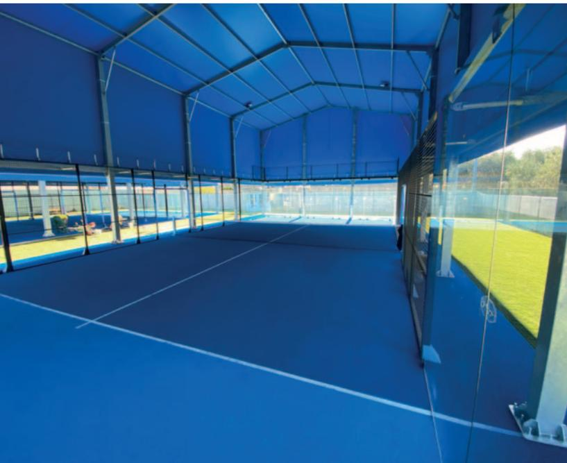
**XPadel AC** è un sistema di pavimentazione progettato per il gioco del padel, composto da un tappeto in gomma riciclata da PFU ad alte prestazioni e da due strati di resina acrilica, il primo funzionale a garantire la planarità ed uniformità della superficie, il secondo in grado di assicurare grip e rimbalzi perfetti.
